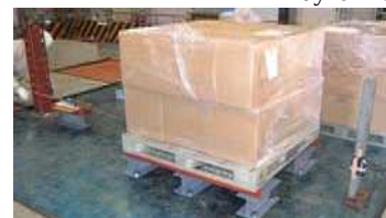
図-3 摩擦係数測定状況の例 (パレットー腕木間) Fig. 3 Experimental setting for friction measurement
