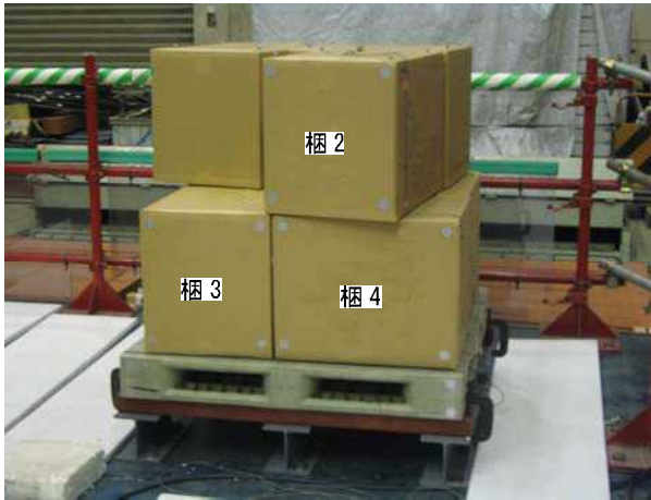
図-7 振動台加振後の状況（パレット固定・JMA 神戸） Fig. 7 Condition of merchandise after experiment (Pallet fixed to arm, JMA Kobe)
