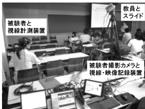
図 1 授業観察における視線計測の機器構成
